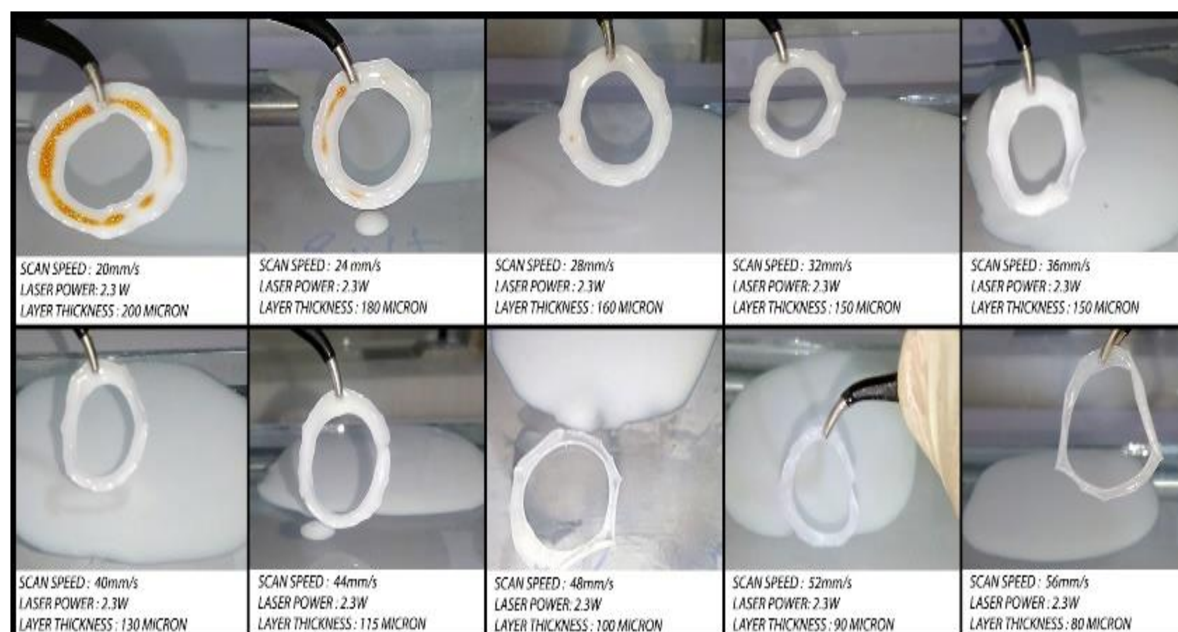
تصویر ۳. نتایج تعدادی از آزمایش های دو بعدی مربوط به شکل گیری آمیزه PVC تحت تابش پرتو لیزر با سرعت اسکن های مختلف
